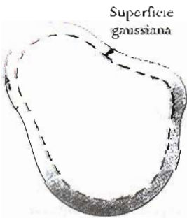
Figura 24.17 Conductor aislado de forma arbitraria. La línea quebrada representa una superficie gaussiana justo en el interior del conductor.
