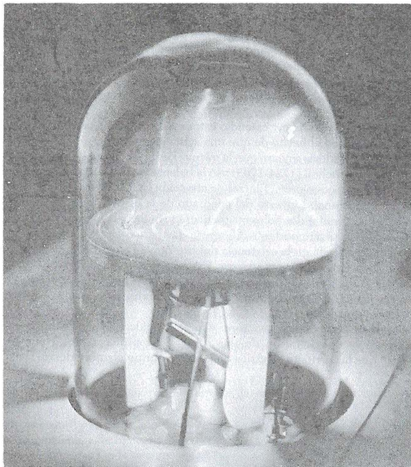
El arco azul en esta fotografía indica la trayectoria circular seguida por el haz de electrones moviéndose en un campo magnético. El recipiente contiene gas a muy baja presión, y el haz se hace visible cuando los electrones chocan con los átomos del gas, lo cual se traduce en luz visible. El campo magnético lo producen dos bobinas (que no se muestran). El aparato puede ser utilizado para medir la razón e/m para los electrones. (Cortesía de CENCO)
