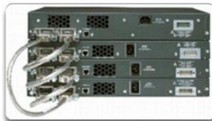
**Switches de configuración apilable**
