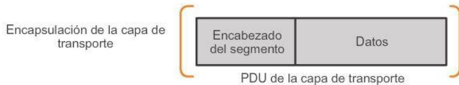
La capa de transporte agrega un encabezado para que los segmentos puedan volver a armarse en el destino.
